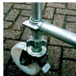
Výškovo nastaviteľné koleso s brzdou
